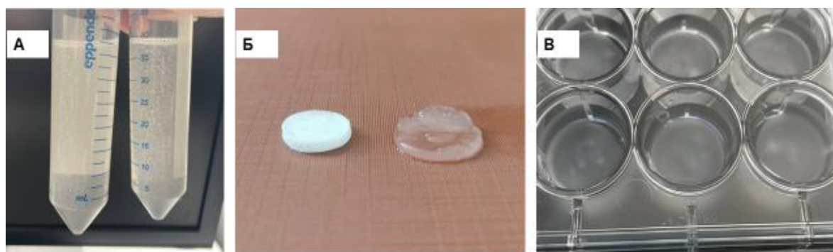
Рисунок 11. Фото композита БЦ-ПЭГ-ПВС. А) в процессе приготовления, Б) слева – в высушенном состоянии; справа - во влажном; В) в процессе отмывки PBS перед посадкой клеток H1299.
