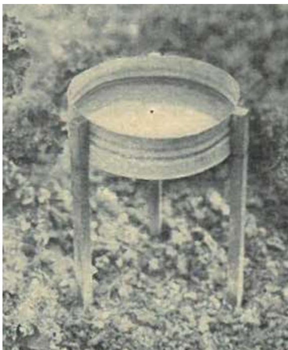
Рис. 2. Ловушка, использованная Мёрике в своих опытах (Moericke, 1951). Жестяная чаша диаметром 22 см и высотой 6 см была заполнена фиксирующей жидкостью на 1–2 см. Ловушка устанавливалась немного выше растений с помощью подставки из трех деревянных планок. Такие ловушки используются в основном для ловли летающих насекомых.
