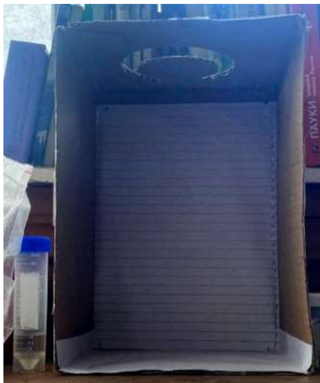
Рис. 3. Съёмочная установка 2024 года. Жука помещали на лист именно внутри коробки, чтобы не утратить его в ходе эксперимента – он мог улететь или заползти куда-либо на столе. Высоту прыжка жука определяли по листу, разлинованному горизонтальными линиями, расстояние между которых составляет 1 см.
