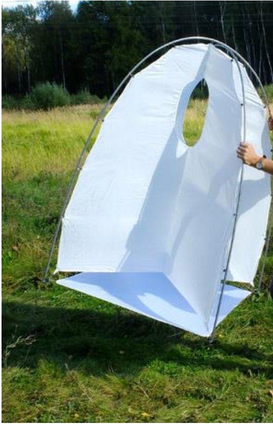
Рис. 2. Светоловушка – четырёхлепестковый экран. Она разделёна на четыре отсека, в отверстии висит лампа. На её свет слетаются насекомые и садятся на лепестки экрана. Более устойчива, чем обычный экран. Изображение с сайта naturaliste.ru
