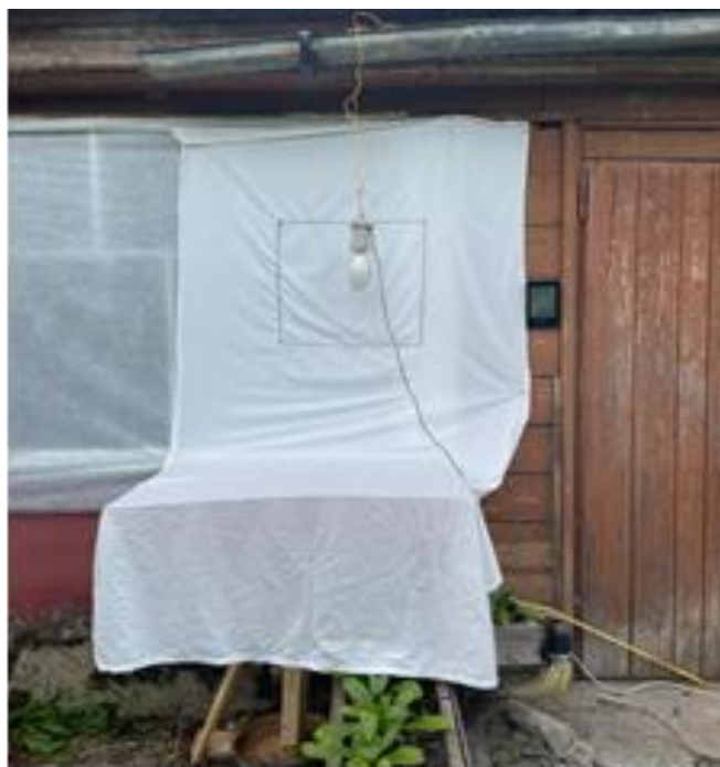
Рис. 7. Установка, состоящая из столика, прибитой над ним к стене белой простыни с квадратом 50 × 50 см. Напротив неё привязана лампа, на свет которой слетались насекомые и садились на установку и стены. Расположена на восточной стене лаборатории, где проводились исследования.
