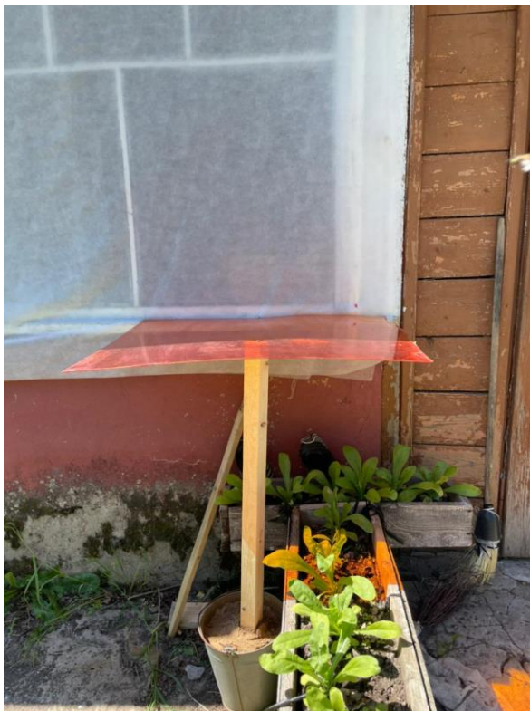
Рис. 6. Каркас установки, к которой летели насекомые. Состоит из деревянной доски, вкопанной в песок и пластиковой пластины. Расположен у восточной стены лаборатории.
